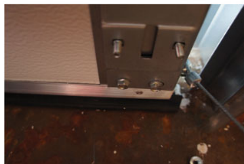
HÄKTA PÅ BÅDA VAJRARNA PÅ UNDERSTA GÅNGJÄRNSBESLAGET.
