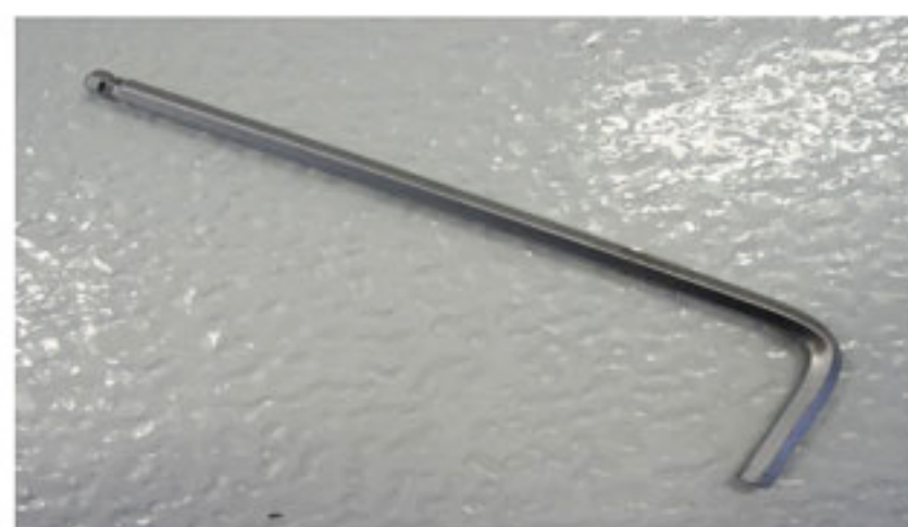
4 MM SEXKANTSNYCKEL FÖR LÅSNING AV "KUGGHJULET" PÅ FJÄDERBROTTS SPÄRREN
