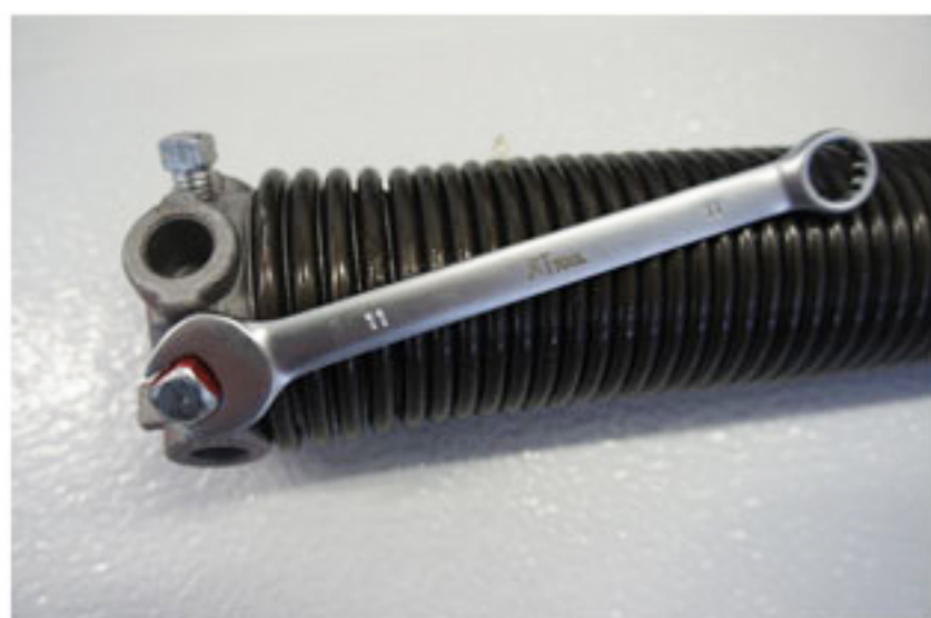
11 MM FAST NYCKEL FÖR SPÄNNING AV LÅSBULTARNA PÅ TOROSIONS-FJÄDERN.
