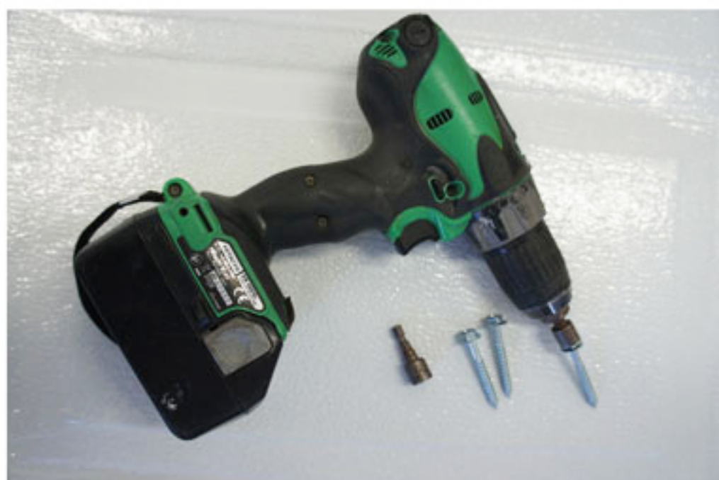
SKRUVDRAGARE MED 10 MM BITS HYLSA MED MAGNET. GÅR ÄVEN MED HYLSA UTAN MAGNET.
