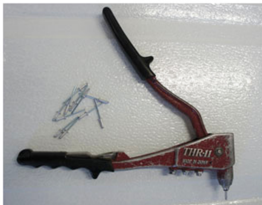
POPPNITTÅNG FÖR 3,2 MM ELLER 4 MM POPPNIT SAMT 3,2 MM ELLER 4 MM BORR. POPPNITARNAS ANVÄNDS FÖR FASTSÄTTNING AV TRÖSKELLISTEN AV ALUMINIUM.
