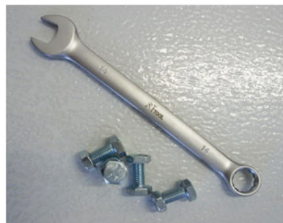
14 MM FAST NYCKEL FÖR BULT OCH MUTTER FÖR FASTSÄTTNING AV DET BAKRE STABILISERINGSSTAGET.
