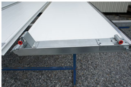
11. PLACERA UT GÅNGJÄRNSBESLAGEN BILDEN VISAR BOTTNELEMENTET
