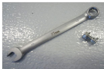
10 MM FAST NYCKEL FÖR MONTAGE AV SKENSKRUVARNA MED MUTTER.
