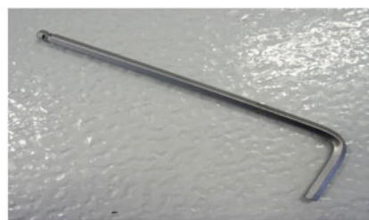
4 MM SEXKANTSNYCKEL FÖR LÅSNING AV "KUGGHJULET" PÅ FJÄDERBROTTS SPÄRREN
